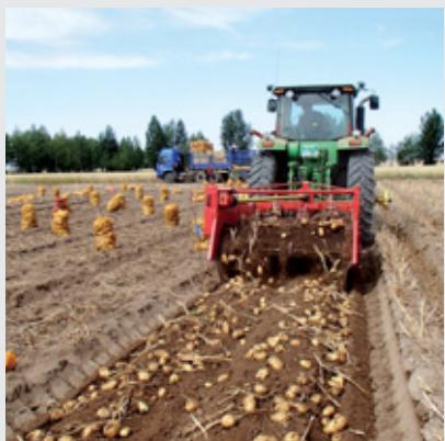
WH 200 – навесной картофелекопатель, сконструированный для различных целей использования: для начинающих в области механической уборки картофеля или других корнеплодов; для двухфазного метода копки, для уборки картофеля со светлой и плотной кожурой; для использования в комбинации с картофелеуборочным комбайном по методу "обогащения" в целях увеличения производительности уборки урожая.
