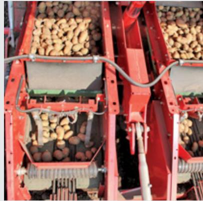
Вид на высаживающий аппарат ленточного типа.
