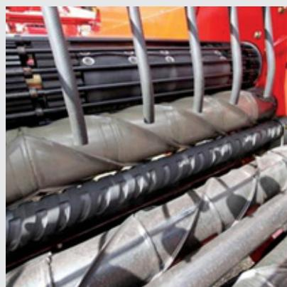
Сепаратор MultiSep – на всех видах почв с большим содержанием комков и небольших камней
