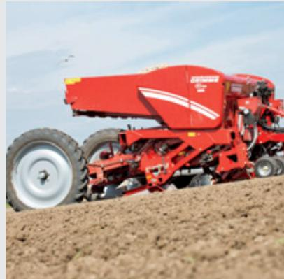
Посадочная машина ременного типа является правильным выбором для тех, кто работает с некалиброванным посадочным материалом\*, сортами длинной формы или разных размеров. При соответствующих размерах возможно достижение более высокой скорости движения, чем
