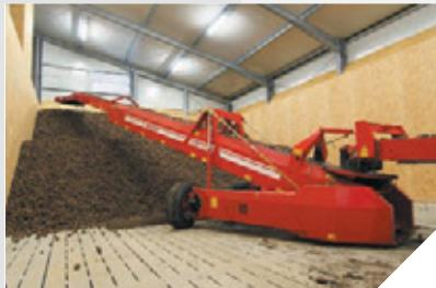
Ленточный погрузчик длиной от 14,5, до 18,5 м с транспортерной лентой шириной 80 см удобен в использовании и обладает высокой производительностью заполнения хранилища картофелем и другими продуктами, такими как лук, морковь или зерновые культуры. Благодаря электрогидравлическому приводу, бесступенчатой регулировке скорости ленты и настройке скорости поворота обеспечивается крайне бережное обращение с продуктом.
