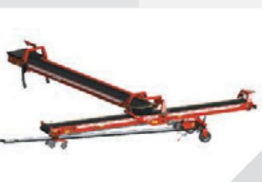
обеспечивают комфорт в использовании. Бесступенчатая регулировка длины дает возможность подсоединения ленточного погрузчика без переоборудования всей линии.
