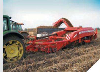
Следующими преимуществами являются гидравлическая разгрузка гребня и независимое ведение глубины TerraControl. Особо бережно работают MultiSep и двойной MultiSep, оснащенные сегментными вальцами, даже в самых тяжелых условиях. Беспрепятственную и бережную передачу продукта обеспечивает длинный перегрузочный элеватор с подвижными боковыми стенками, глубоко опускающийся в прицеп транспортного средства.
